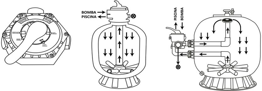
El agua de la piscina se toma a través de los drenes de fondo (succión de la motobomba), después de realizar un prefiltrado a través de motobomba, esta misma la envía al filtro PANDA para pasar a través de la media filtrante (arena), ingresa posteriormente a las crepinas y se regresa ya filtrada a través del tubo central para ingresar nuevamente a la piscina por las boquillas de retorno.
