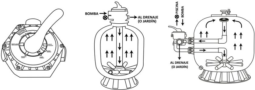
El agua de la piscina se toma a través de los drenes de fondo (succión de la motobomba), después de realizar un prefiltrado a través de motobomba, esta misma la envía al filtro PANDA para pasar a través del tubo central, posteriormente por las crepinas y la media filtrante (arena), para finalmente salir al drenaje y dejar la arena libre de suciedad.
