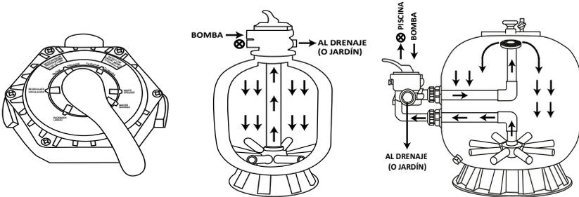
El agua de la piscina se toma a través de los drenes de fondo (succión de la motobomba), después de realizar un prefiltrado a través de motobomba, esta misma la envía al filtro PANDA para pasar a través de la media filtrante (arena), ingresa posteriormente a las crepinas y se regresa ya filtrada a través del tubo central para enviarse al drenaje y dar un último lavado a la arena.
