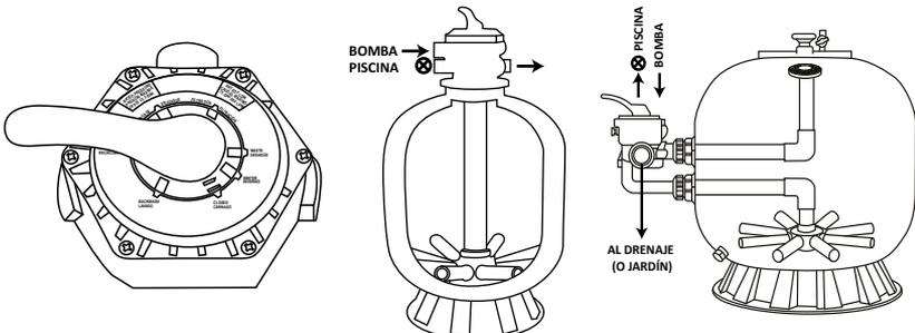
En este proceso el agua no pasa a través de la media filtrante (arena), ni tampoco a través de las crepinas y tubo central.
