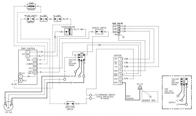
Fig. 19: Wiring Diagram—Analog Models
