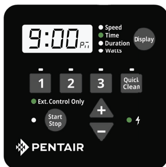
Figura 4: Activación del modo de control externo solamente
